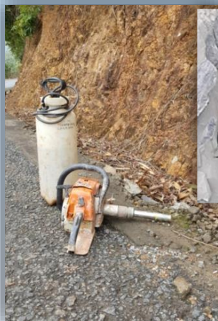
Campionatore carotiere e tavolino orientatore. Raccolta campioni cilindrici per analisi paleomagnetiche
